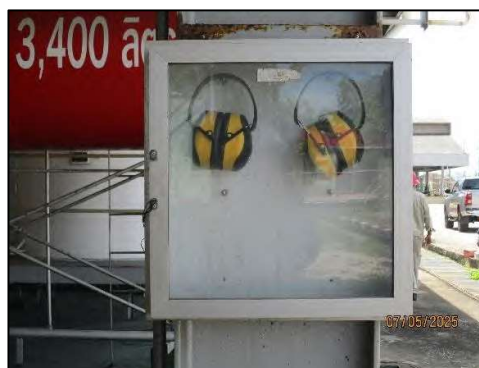
ภาพถ่ายที่ 2.2-4 ป้ายเตือนให้สวมใส่อุปกรณ์ป้องกันเสียง และการจัดเตรียมอุปกรณ์ป้องกันเสียงส่วนบุคคล สำหรับพื้นที่ปฏิบัติงาน
